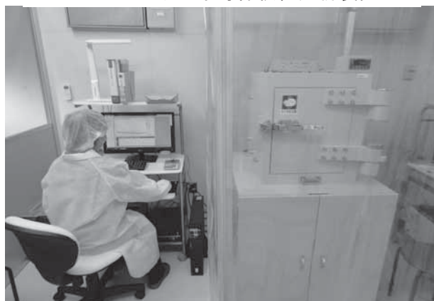
ゲルマニウム半導体核種 分析装置（右）による食 品検査の様子
