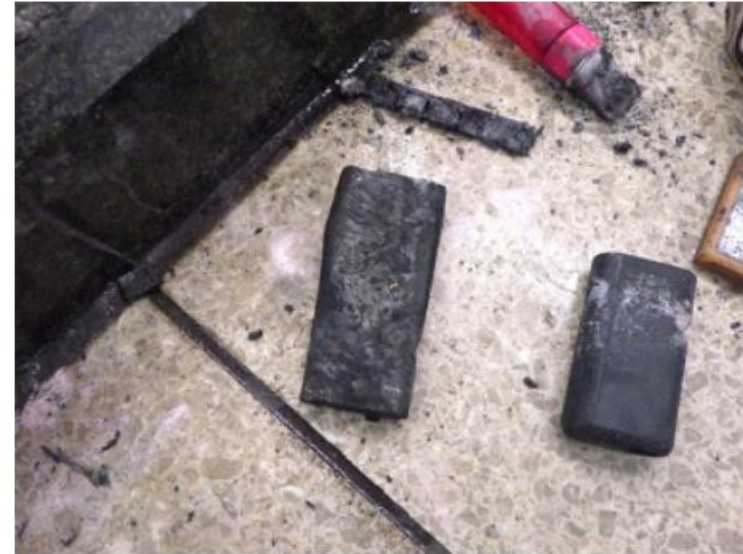
モバイルバッテリーの焼損状況
