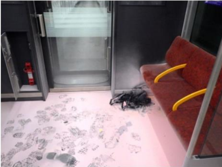
電車内の焼損状況
