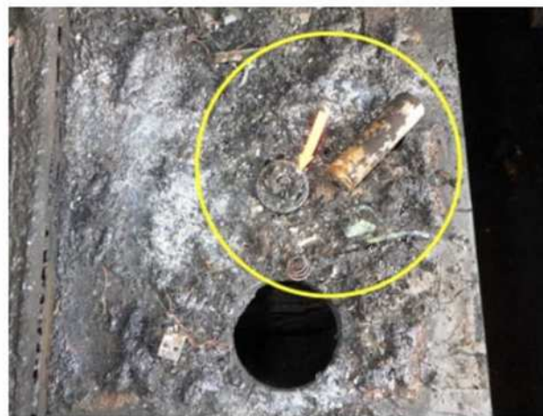
携帯型扇風機の焼損状況
