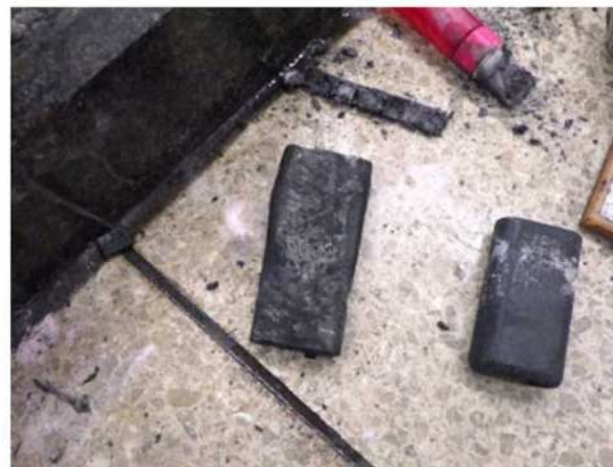
モバイルバッテリーの焼損状況
