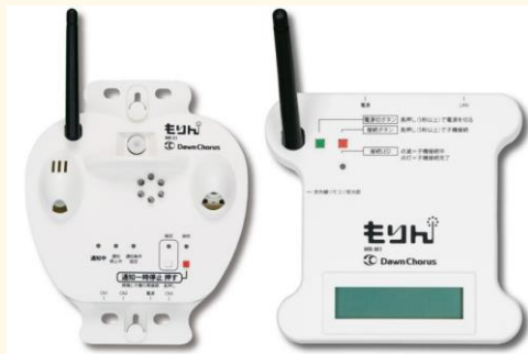
見守りシステムの親機・子機。 非接触型のため、利用者の安眠を妨げない。
