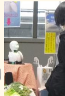
分身ロボット「OriHime」。 専用のタブレット端末から、会話や基本的な操作を行うことが可能。 （写真は駅での野菜販売の様子）
