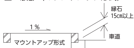
【図4.2】横断歩道部における構造
