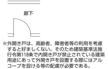
【図2.8】車椅子使用者のための開閉スペースの設置
