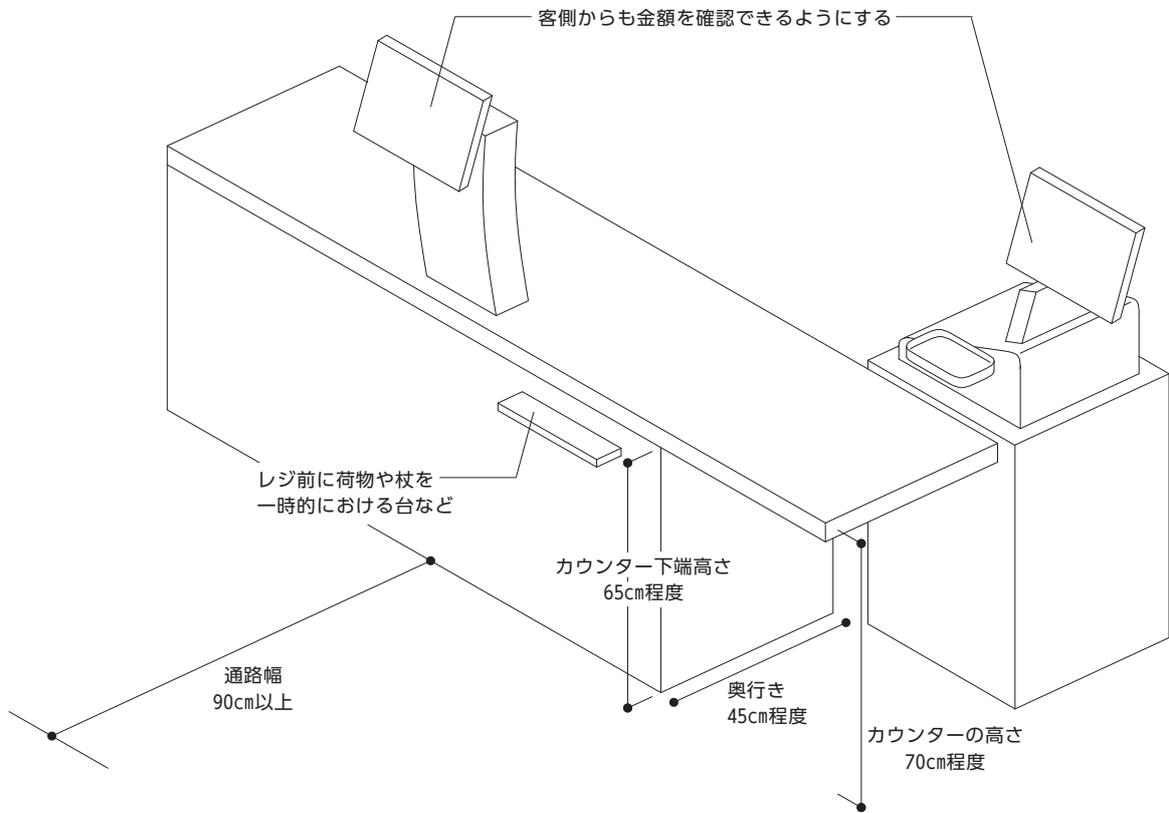
【図29.4】 サッカー台の例
