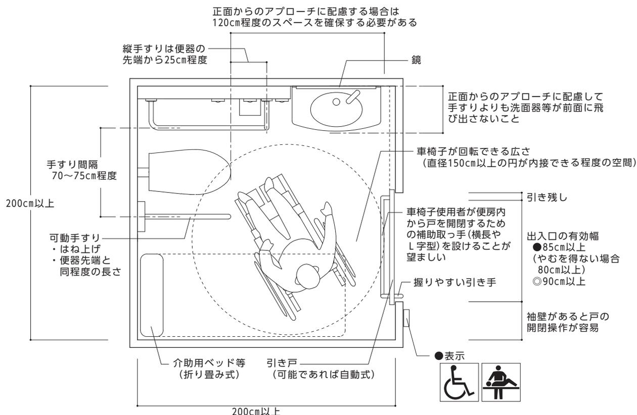
※介助用ベッド：折り畳み式介助用ベッド等を設置する場合、畳み忘れであっても、車椅子での出入りが可能となるよう、車椅子に乗ったままでも畳める構造、位置とすることが望ましい。また、次使用する人のために折り畳んでから退室するよう注意喚起を行う。
