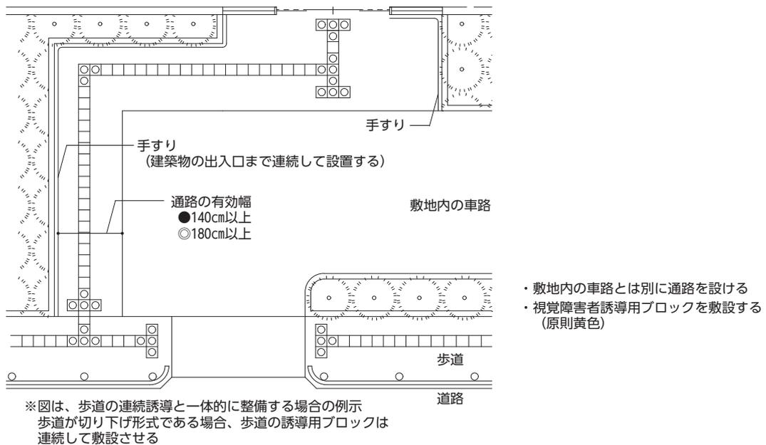
【図12.3】 階段と傾斜路を併設した敷地内の通路
