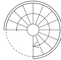
【図4.7】 視覚障害者に対する階段下の安全確保の措置の例
