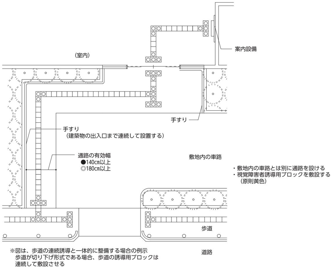
【図16.2】 出入口(玄関)付近での設置例
