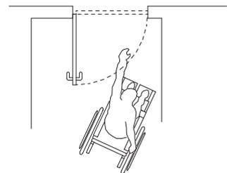
※袖壁は、引き戸の場合は30cm以上、開き戸の場合は45cm以上を確保すると、車椅子使用者が戸を開閉しやすい。また、必要となる袖壁と開閉スペースは、戸の開閉機構、取っ手の形状、周囲の状況等によって異なるため、設計にあたってはそれらを考慮したうえで、袖壁と開閉スペースを確保する。
