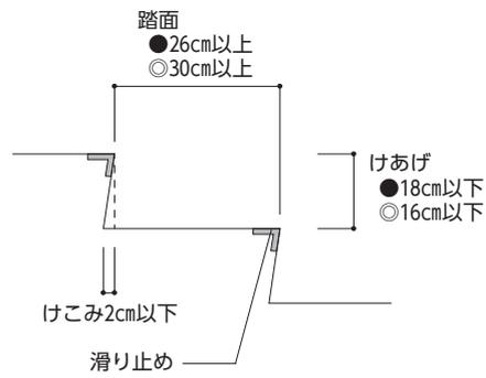
【図4.4】 けあげ、踏面の形状（つまずきにくい構造の例）
