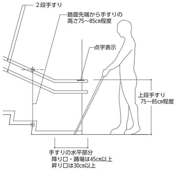
【図27.5】 傾斜路の手すりの例
