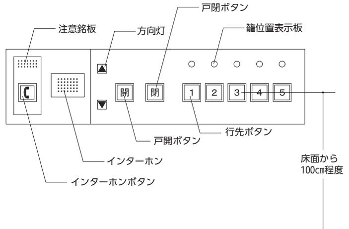
【図6.6】 車椅子使用者対応副操作盤
