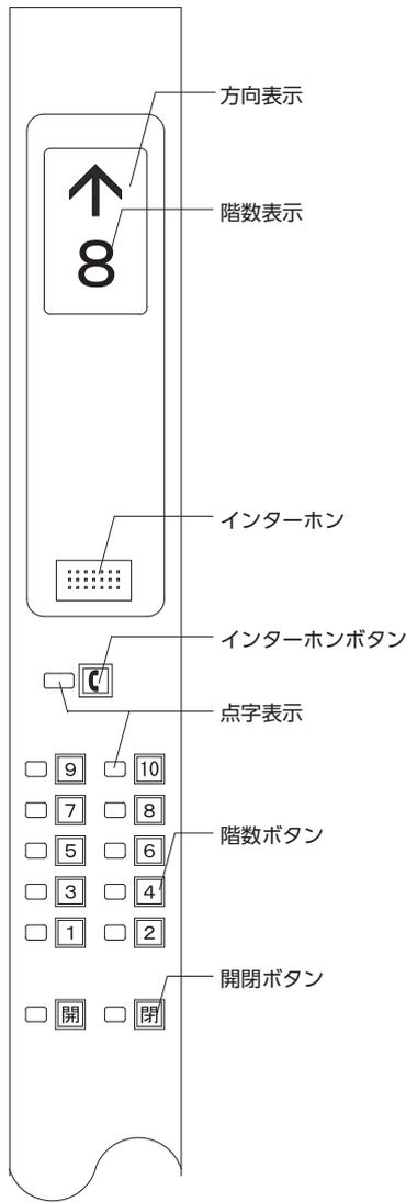
【図6.5】 車椅子使用者対応主操作盤
