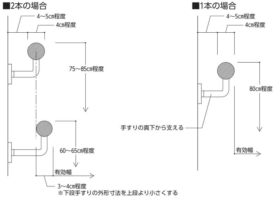
【図27.2】 壁面の設置例
